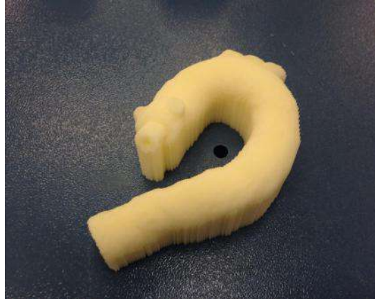
Figura 14. Modelo aórtico com material de suporte. Modelo aórtico tridimensional, ainda com material de suporte utilizado na técnica de prototipagem rápida.
