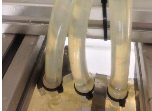
Figura 19. Conectores dos vasos do arco aórtico. Mangueiras e conectores hidráulicos dos segmentos correspondentes aos vasos do arco aórtico do fantoma vascular.
