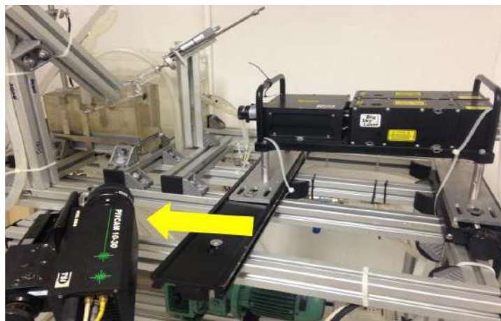
Figura 27. Câmera digital. Câmera digital direcionada para região de análise do modelo aórtico (seta amarela).
