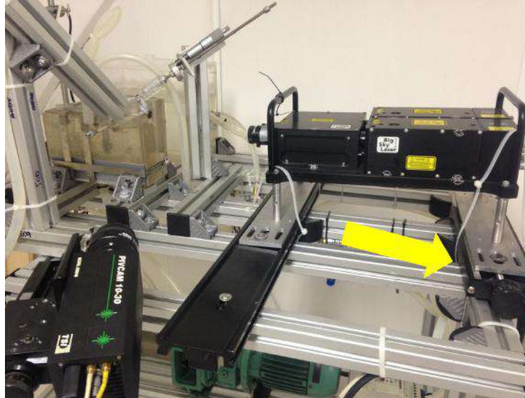
Figura 39. Mesa de coordenadas. Laser acoplado à mesa de coordenadas milimétrica (seta amarela).
