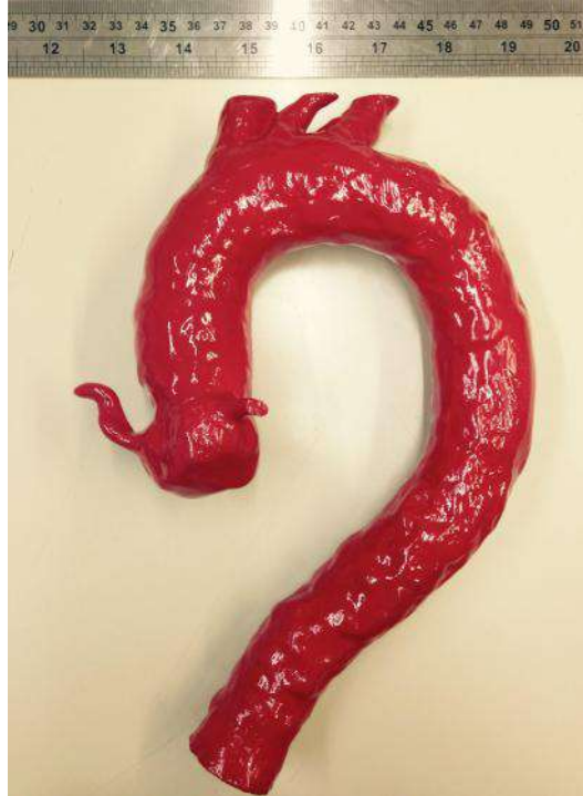
Figura 15. Modelo aórtico tridimensional. Modelo aórtico 3D em material termoplástico ABS-M30 Affordable FDM (Stratasys, EUA) impresso no equipamento Stratasys Fortus 400 mc Systems (Stratasys, EUA). Núcleo de Experimentação Tridimensional – NEXT, PUC-Rio.
