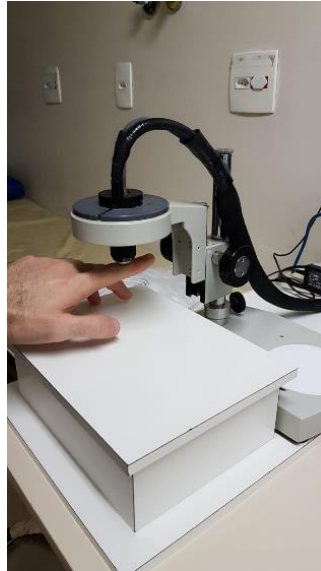
Figura 7: Aparelho de microscopia intravital de alta resolução em cores (Moritex, Cambridge, UK),
