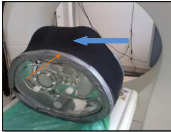
Figura 14: Simulador antropomórfico: simuladores mamários anexados com auxílio do suporte elástico (seta azul) e simulador de gordura (seta vermelha)
