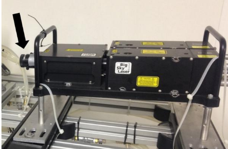
Figura 26. Laser e conjunto de lentes. Laser utilizado como fonte de iluminação e conjunto de lentes acoplado ao bocal de saída (seta preta).
