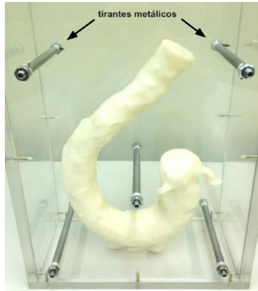
Figura 17. Recipiente de acrílico. Recipiente de acrílico com o modelo aórtico 3D (não impermeabilizado) em seu interior, antes da colocação do elastômero de silicone. As setas evidenciam os tirantes metálicos responsáveis pelo posterior acoplamento das partes de silicone do fantoma aórtico.
